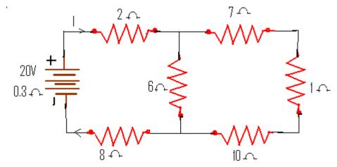
8.- Para el circuito que se indica determine la corriente I que fluye a través de la batería (2A)
