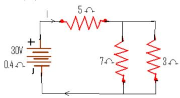
7.- Para el circuito que se indica determine la corriente I que fluye a través de la batería (1.35A)
