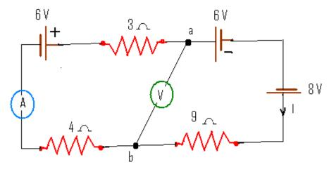
19.- En el circuito, la resistencia de 4  $\Omega$  produce 23,9 cal de calor cada seg. Supóngase que el amperímetro A y los voltímetros V' y V'' son ideales. ¿Cuales serian sus lecturas? (5.8 A, 8 V, 58 V)
