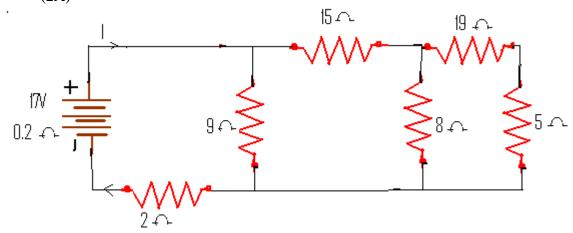
9.- Para el circuito que se indica, determine la corriente en cada resistor y la corriente que sale de la batería.
